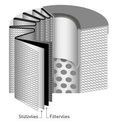
Trennen Sie aus dem Stützgewebe eine rechteckige Fläche z.B. mit einer Drahtschere oder einem Cutter auf. Schneiden Sie lediglich ein repräsentatives Stück (ca. 50 x 50 mm) heraus und senden Sie davon nur das Filtervlies.
