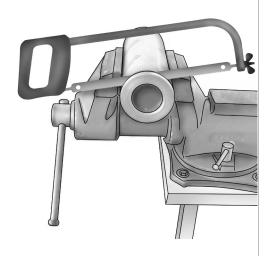
Lassen Sie das Bauteil zunächst austropfen. Öffnen Sie das Gehäuse, um an die Filterpatrone zu gelangen. Fixieren Sie das Bauteil dazu ggf. in einem Schraubstock oder mithilfe von Schraubzwingen und trennen Sie es mittels eines Winkelschleifers oder einer Eisensäge auf.
