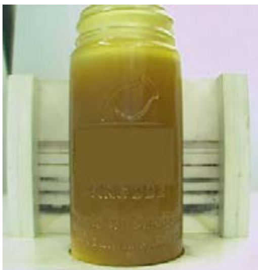
Bild 5: Trübung eines mineralölbasischen Getriebeöls durch Eintrag eines Polyglykols
