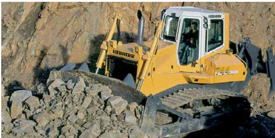
Liebherr Planierraupe PR 744 Litronic mit hydrostatischem Fahrtrieb
