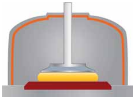
Messprinzip für die Bestimmung der Viskosität bei Schmierfetten
