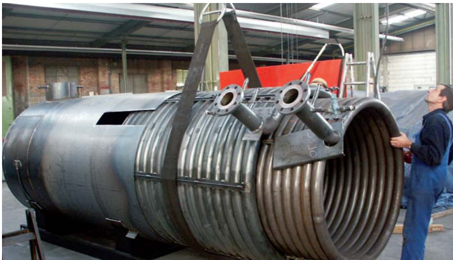
Fertigung einer Wärmeträgeranlage: Einführung der Rohrschlange in den Kesselmantel
