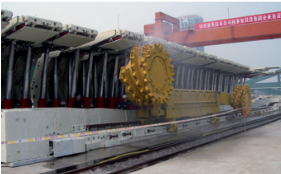
Aufbau eines Eickhoff Walzenladers vor dem Einsatz im Untertagebergbau in Huainan/China.
