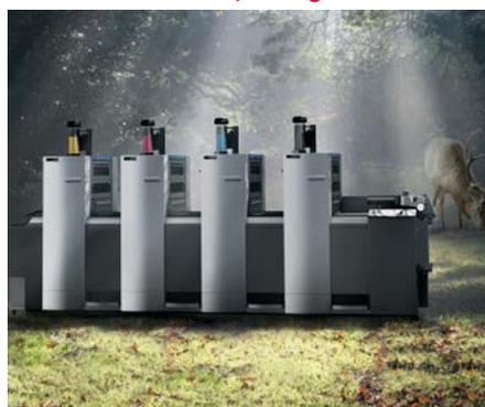
Für die Schmierung der Druckmaschinen kommt in der Regel ein mineralölbasisches Industriegetriebeöl vom Typ CLP 150 zum Einsatz. Je nach Maschinentyp und Anzahl der Druckwerke werden 50 bis 150 Liter Getriebeöl benötigt.
