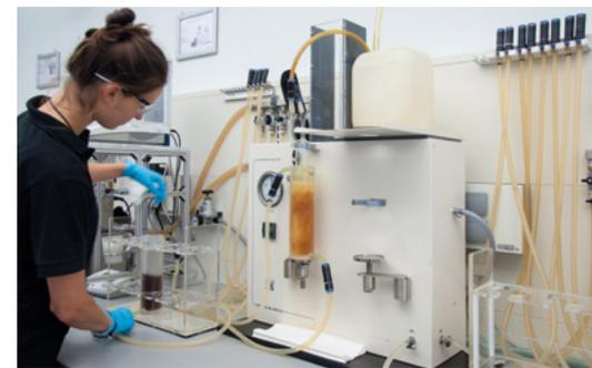
Bestimmung des LAV im OELCHECK-Labor mit dem Prüfnormlab Analis P 688
