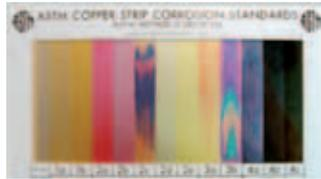
Vergleichsskala für Kupfer-Korrosion
