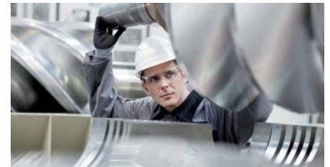
Einsetzen eines Rotors in das Gleitlager
