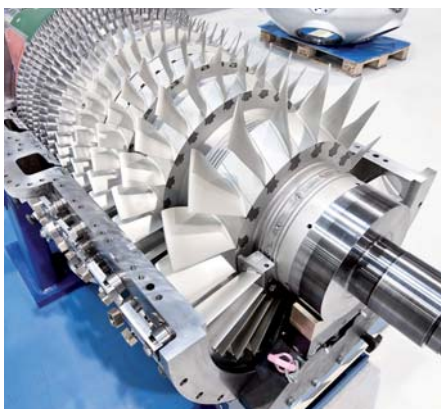
Einblick in eine 6,9 MW Gasturbine
